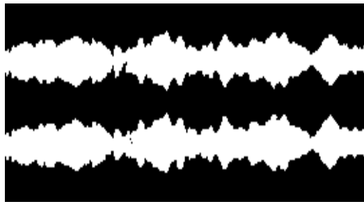
Рис. 9. Вид двухдорожечной одноканальной фонограммы (моно)
