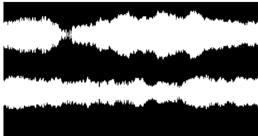
Рис. 10. Вид двухдорожечная стереофонограмма (четырёхканальная) Dolby Stereo
